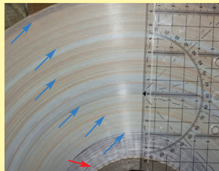
Etikettenrolle mit axialen Fehlschnitten (roter Pfeil: Rattermarken, blaue Pfeile: axiale Fehlschnitte).
